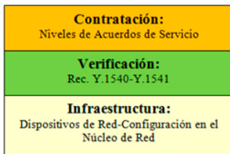
Figura 1. Estratos dentro de la capa de QoS en una red NGN (Cuellar, 2010)
